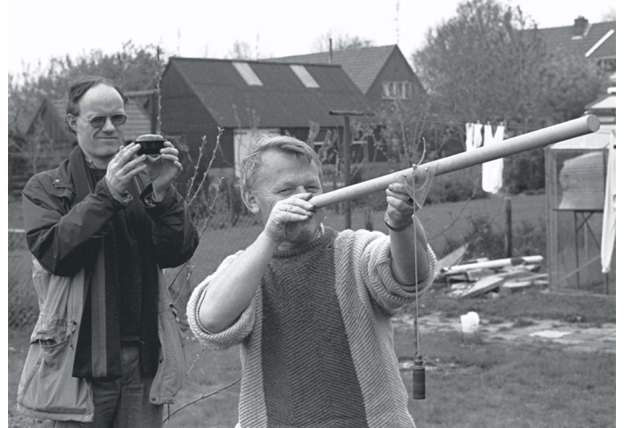
Figure 2: Metingen te Bergentheim. De kompasrichtingen worden bepaald, door over de waarnemer heen langs de lat te kijken met een (scheeps)kompas.
