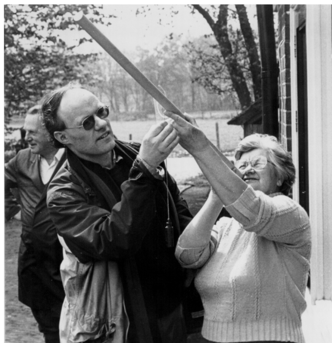
Figure 1: Metingen bij de familie Spiele te Hengelo. De hoogte wordt gemeten door de waarnemer langs een lat te laten kijken, waaraan een gradenboog met een schietlood is bevestigd.
